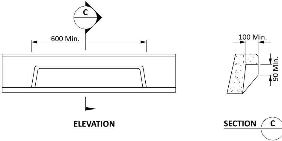
**DETAIL B - PRECAST KERB COMPONENT**
